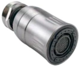
El aireador dual giratorio ofrece dos opciones de aspersión: una corriente de fuerza múltiple y el patrón de libre salpicadura que se puede variar de forma giratoria. Posee tecnología de compensación de presión para un flujo constante de agua. El cabezal de este aireador se puede re- direccionar con giro de 360 grados hacia donde se necesite. Se ajusta a conexión estándar ya sea rosca interna o externa. Las medidas del diámetro de la rosca son: INTERNA 15/16-27 y EXTERNA 55/64-27
